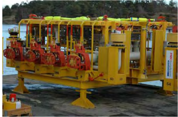
4.1.c Un distribuidor de flujo central del proyecto Norne en Noruega, [Grenland, 2009]
