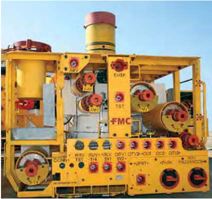
4.1.b Un árbol submarino horizontal de 15,000 Psi [FMC,2009]
